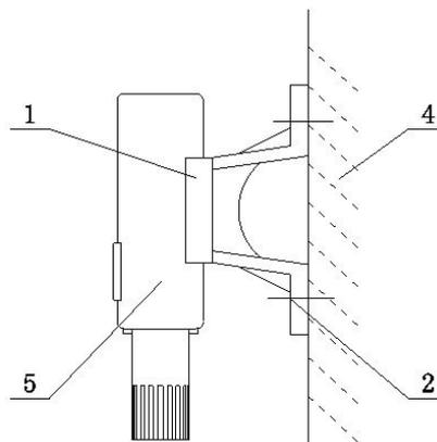
1. 一种挂装式温湿度监控记录仪,其特征在于:安装支架(1)的两端设置有安装孔(2),安装支架(1)的顶部设置有挂钩式第一卡扣(3),螺栓安装在安装孔(2)中将安装支架(1)固定于墙面(4)上;
