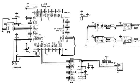
1. 一种低功耗温湿度记录仪,其特征在于,所述低功耗温湿度记录仪包括微控制器(U1)、若干外部储存器、温湿度传感器(SENSOR1)、通用串口总线芯片(U6)及通用串口接口(J1);
