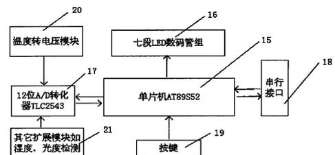
1. 一种检测大棚温湿度光照的记录仪，包括单片机（15），及与其连接的LED数码管组（16）、A/D模数转换器（17）、RS232串行接口（18）、键盘（19），其特征在于，A/D模数转换器（17）还连接有温度转电压模块（20）和用于检测湿度和光度的扩展模块（21）。
