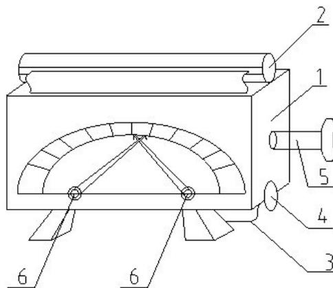
1. 一种温湿度记录仪,其特征在于:包括温湿度计(1)、计时装置、记录纸盒(2)、记录纸(3)、滚筒(4)和发条(5),温湿度计(1)包括仪表盘和指针,计时装置位于温湿度计(1)内部,计时装置通过发条(5)调节,滚筒(4)连接计时装置并跟随计时装置转动,记录纸盒(2)设于温湿度计(1)上部,记录纸(3)放置于记录纸盒(2)内,滚筒(4)带动记录纸(3)穿过温湿度计(1)仪表盘,指针针尖设有折角并贴于记录纸(3)上。
