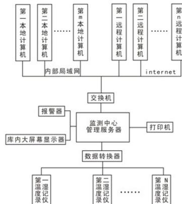
1. 一种药品库房温湿度智能监测系统,其特征在于:包括监测中心管理服务器、数据转换器、温湿度记录仪、报警器和库内大屏幕显示器,所述温湿度记录仪的数据传输端口通过所述数据转换器与所述监测中心管理服务器的数据端口连接,所述监测中心管理服务器的显示信号输出端与所述库内大屏幕显示器的信号输入端连接,所述监测中心管理服务器的报警信号输出端与所述报警器的信号输入端连接。
